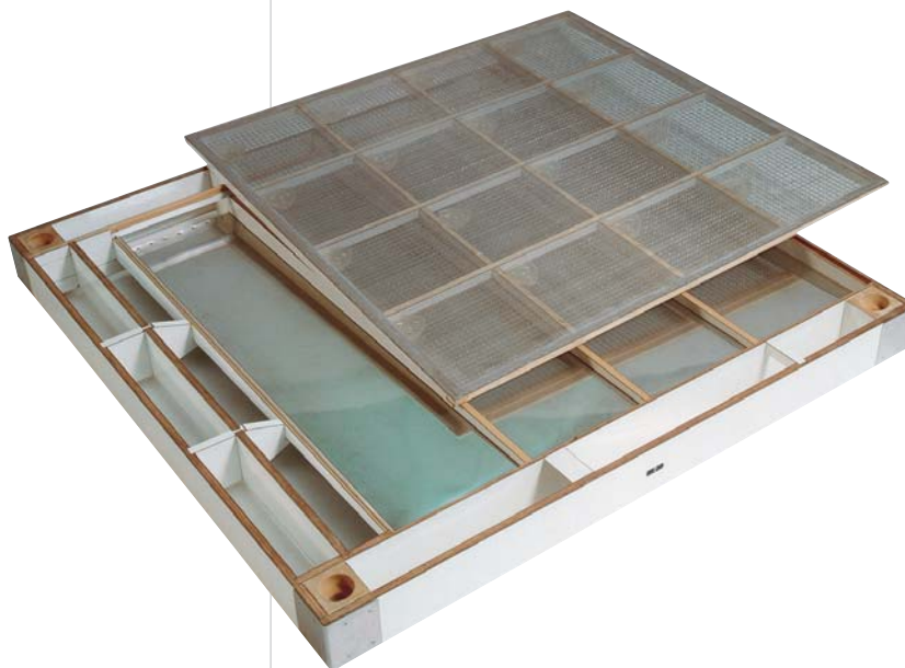
Particolare dello staccio con telai portavelo Detail of sieve with sieve holding frame
